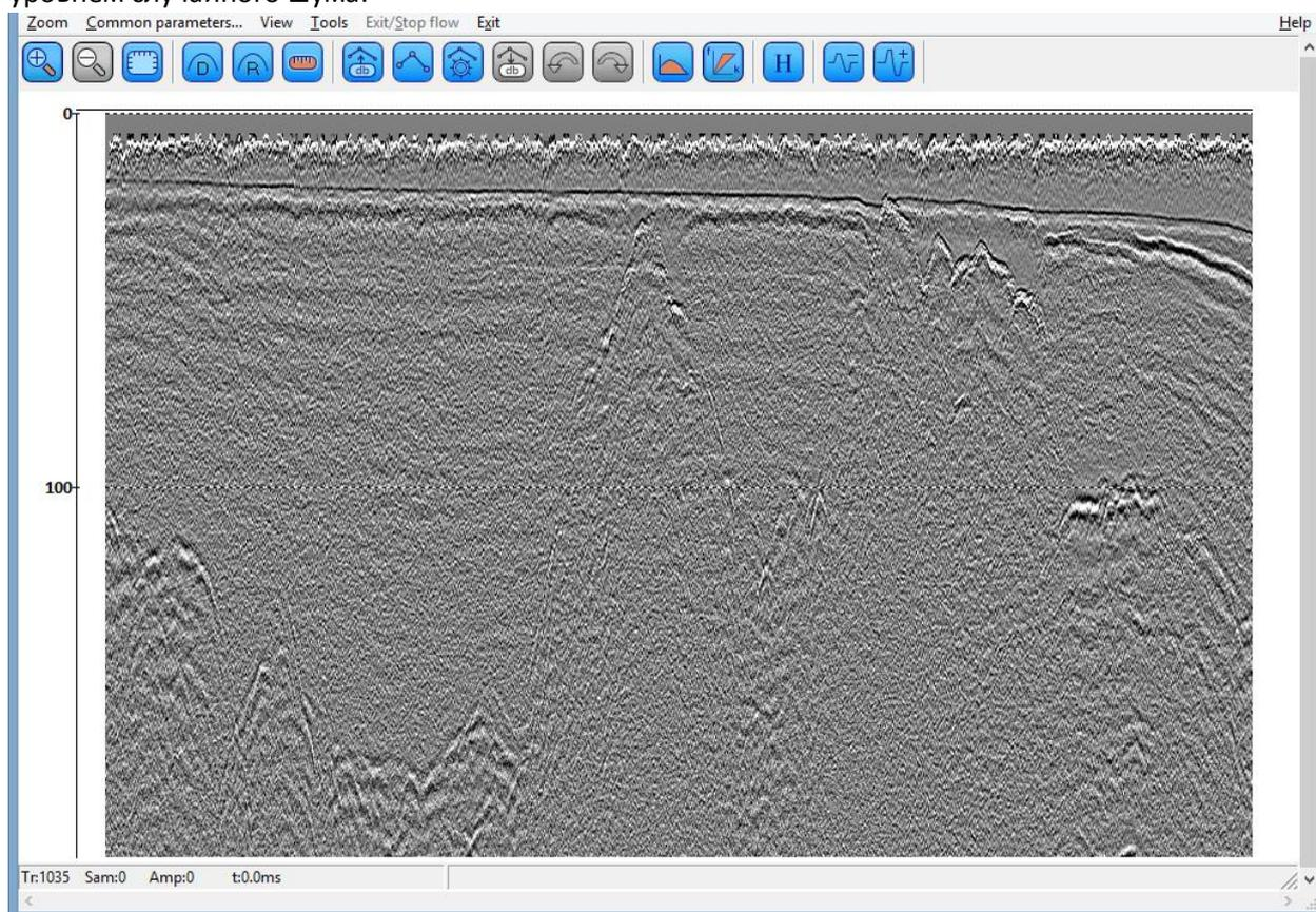
Тот же разрез после применения к нему модуля F-K Amplitude Power в скользящих окнах:
