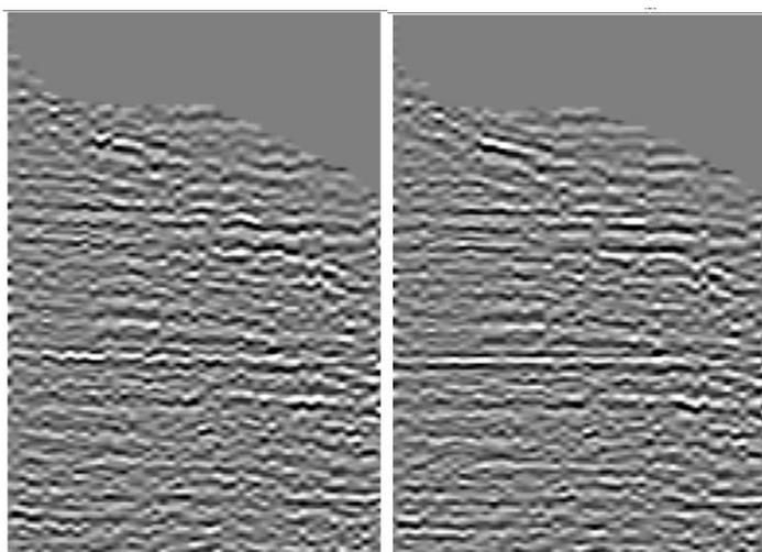
*Слева – исходная сейсмограмма ОСТ с введенной кинематикой, справа – она же с введенными корреляционными статическими поправками*
