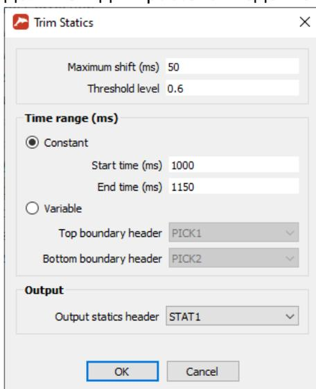
Для каждого ансамбля модуль получает суммотрассу и рассчитывает ФВК между ней и каждой трассой ансамбля во временном окне. Время максимума ФВК для каждой трассы сохраняются в заголовок как статическая поправка.
